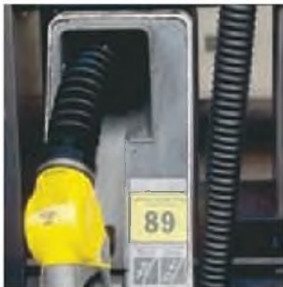
▲ Figura 25.8 Octanaje. El octanaje de la gasolina mide su resistencia a la detonación cuando hace combustión en un motor. El octanaje de estas gasolinas es de 87, 93 y 89, como muestra la carátula de la bomba.
